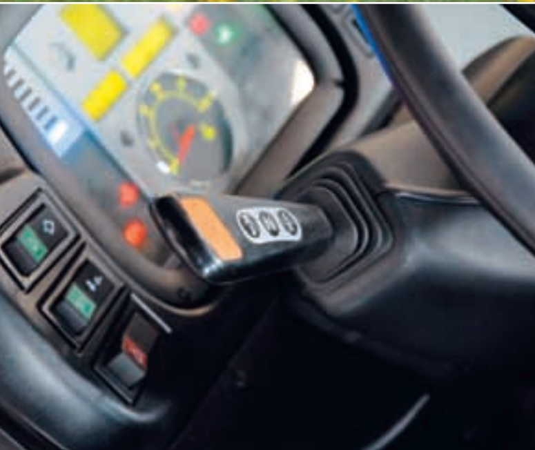
Der Hebel für das Powershuttle befindet sich unter dem Lenkrad.
